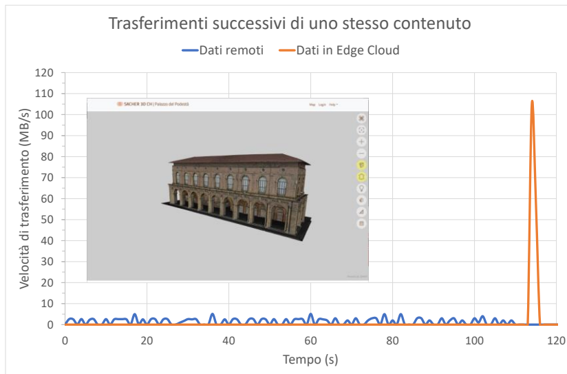
Figura 15. Trasferimento dati del medesimo contenuto senza (linea blu) e con (linea arancio) il meccanismo di caching. Il miglioramento di prestazioni può essere molto rilevante.
